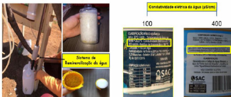
FIGURA 3. Funcionamento do sistema de remineralização (à esquerda) e comparação dos resultados obtidos no processo.
