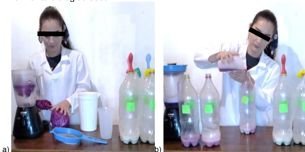
a) Preparo do indicador de pH a base de repolho-roxo; b) mistura do indicador ácido-base nas garrafas que contêm fermento biológico seco.
