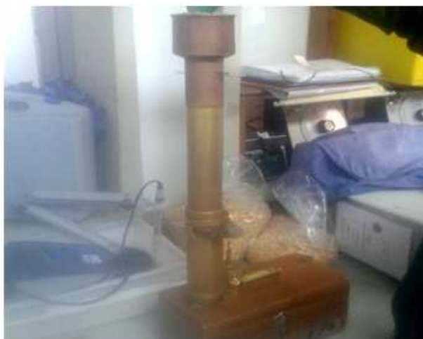
FIGURA 1 Determinação do peso hectolétrico das sementes de linhaça utilizando balança hectolétrica.
