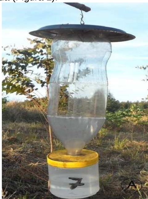
Figura 1- Armadilhas entomológicas confeccionadas a partir de materiais recicláveis: A- Armadilha modelo Carvalho – 47 (adaptada); B- Armadilha modelo bandeja amarela.
