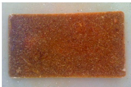
FIGURA 2- painel com 10% de madeira
