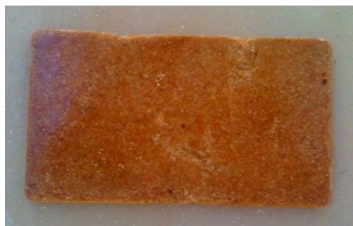
FIGURA 3- Painel com 20% de madeira
