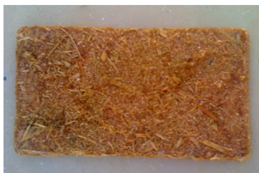
FIGURA 4- Painel com 30% de madeira
