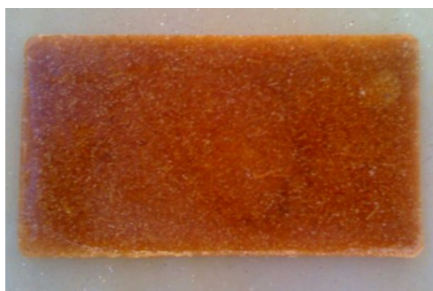
FIGURA 1- Painel com 5% de madeira
