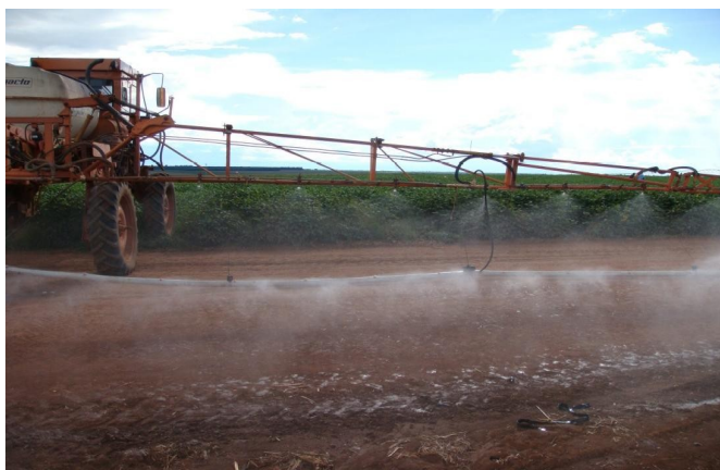
Figura 1. Barra auxiliar montada abaixo da barra principal do pulverizador.
