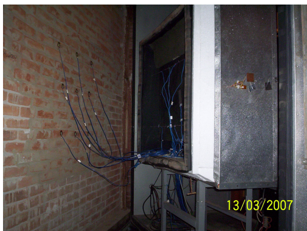
FIGURA 1- Parede ensaiada na caixa quente protegida
