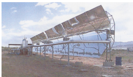
Figura 4.20. Concentrador cilíndrico-parabólico (foco linear)
