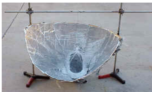
Figura 5.30 - Fogão solar construído no Laboratório de Máquinas Hidráulicas e Energia Solar (LMHES).
