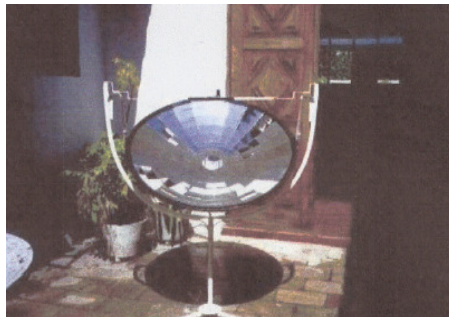
Figura 4.21. Concentrador Parabólico (foco pontual)
