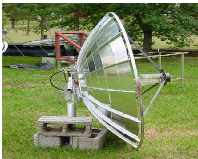
Figura 5.17. Vista lateral da curva contornada do concentrador, onde ele pode ser visto seis anéis consecutivos sustentam diretamente nos braços e os espaços não livres esta entre a esquerda deles.
