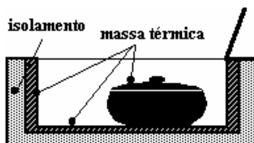
Figura 7.8. Massa térmica dentro do fogão solar.
