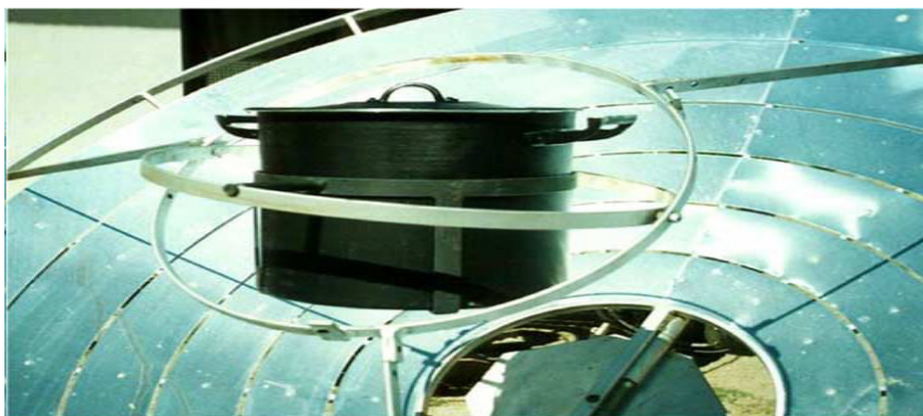
Figura 5.22. Esta figura mostra um conjunto de fogão ocupado por um pote com 10 litros como absorvedor no concentrador.
