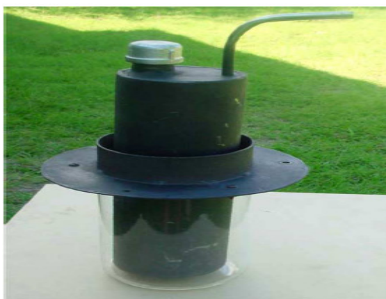
Figura 5.19. Esta mostra o absorvente do tipo fervedor, na qual são postos 2 litros de água, que alcança o ponto de fervura produzindo vapor que sai através de um dos canos e é transportado através de uma encanação flexível.
