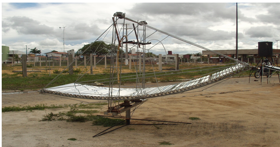
Figura 5.7. Concentrador Cilindro-Parabólico construído no LMHES da UFRN.
