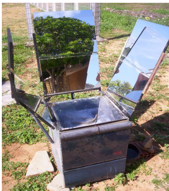
Figura 5.1. Fogão solar tipo caixa de baixo custo do Laboratório de Maquinas Hidráulicas e Energia Solar da UFRN/LMHES.
